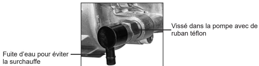
L'arrière de la pompe est refroidi en maintenant le bon niveau et qualité d'huile dans la pompe à huile. Toujours surveiller le niveau d'huile à l'arrière de la pompe en utilisant la jauge ou la jauge visuelle. Utiliser l'huile non détergent 30W si besoin d'ajouter ou de changer.
